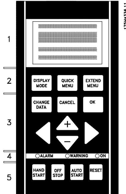
■ Control keys for parameter setup
